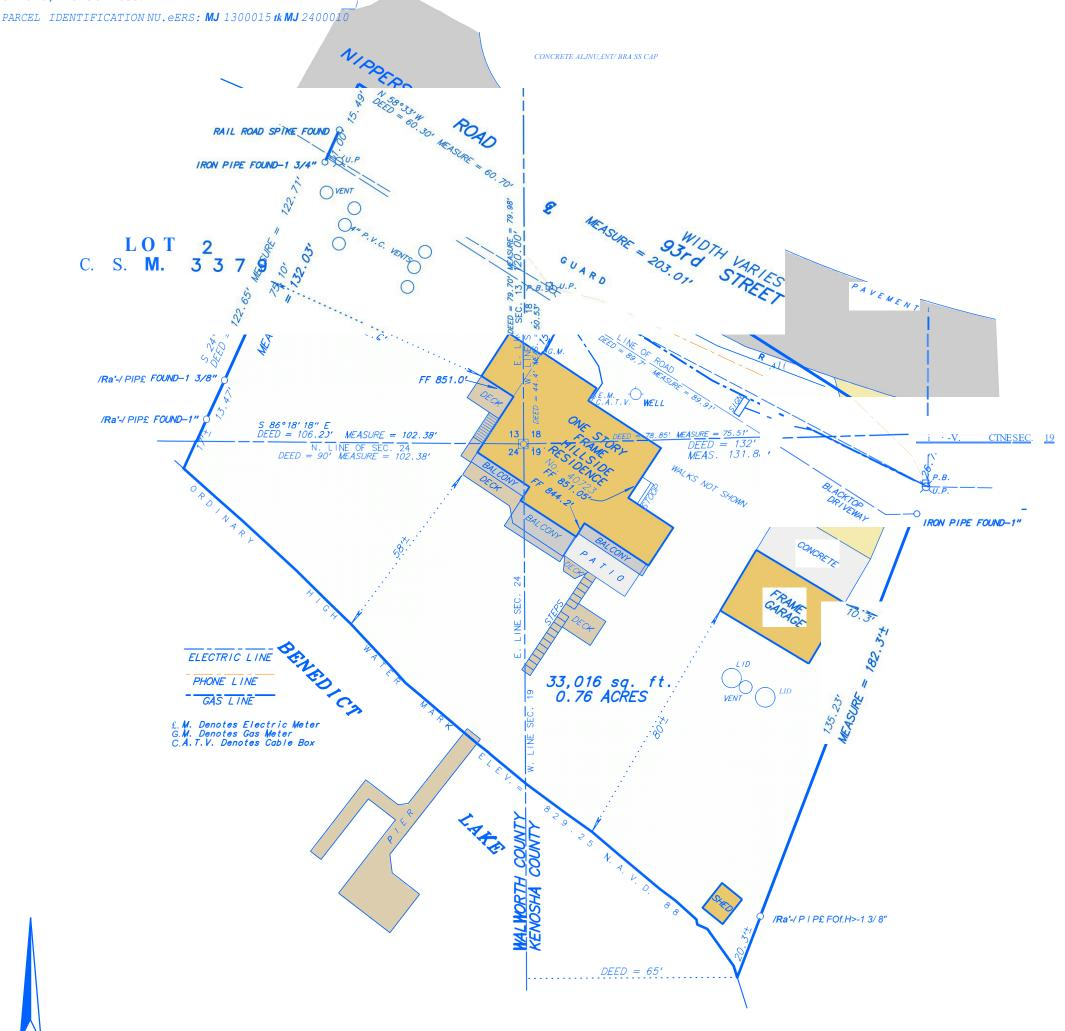
ORTHOMETRIC HEIGHT (GROUND ELEVATION) IS DETERMINED FROM USING GLOBAL NAVIGATION SATELLITE SYSTEM (GNSS), THE VERTICAL DATUM BASIS IS NAVD88 AND THE GEOID MODEL IS GEOID12B CONUS
